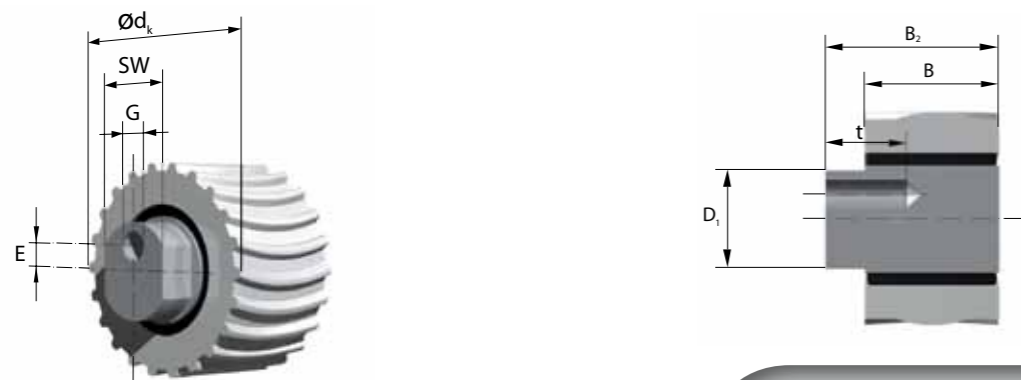
Tension roller (BAT profile)
